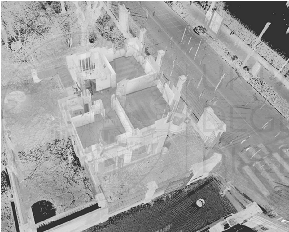
Alcune fasi del rilievo geometrico con laser scanner
